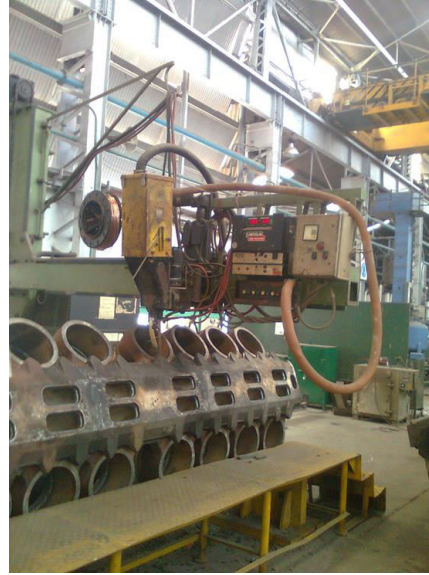
Fig 11:Top Deck SA Welding
